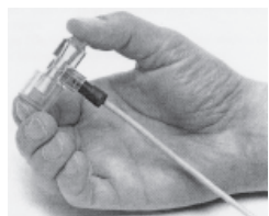
フローセンサの両端を閉塞
